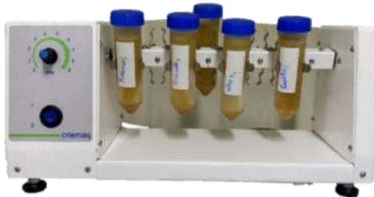
**Figura 2.** Agitador rotativo para tubos Falcon (Criemaq C-385).
