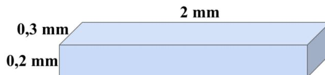
Figura 3.8: Formato de amostra recomendado para montagem da célula de pressão uniaxial.
