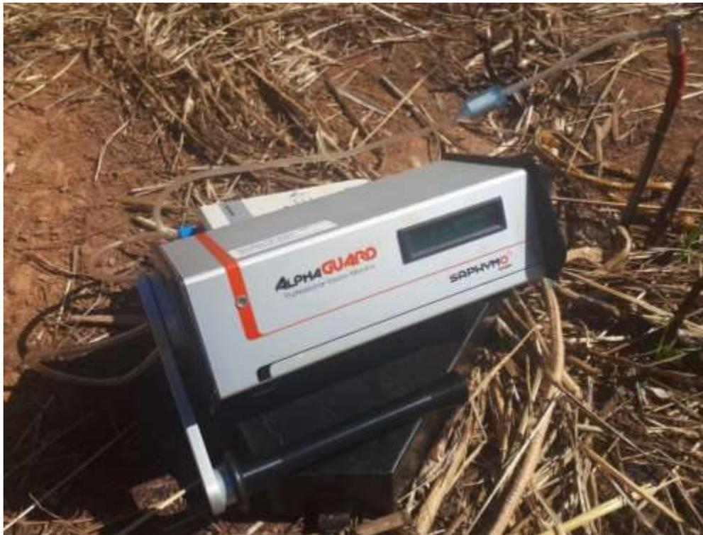
Figura 10: Equipamento *AlphaGUARD*<sup>®</sup>. (Fonte: Próprio Autor)
