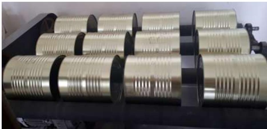
Figura 13: Moinho de jarros com os recipientes metálicos contendo as amostras e esferas para moagem. (Fonte: Próprio Autor)
