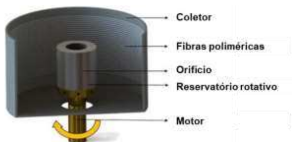
Figura 4. Representação do equipamento de rotofiação utilizado para fabricação de membranas fibrosas. Modificada de RODRIGUES et al., 2020a.
