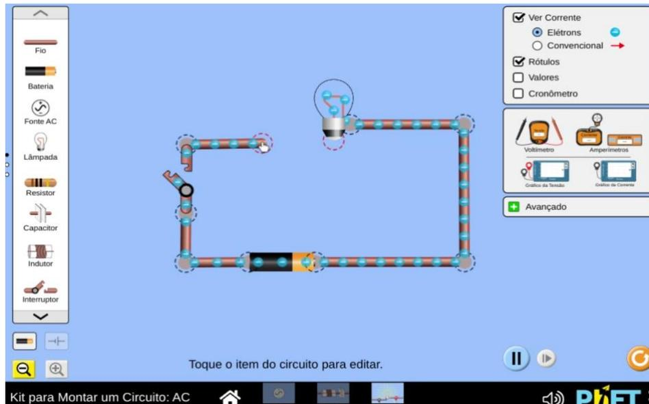
Descrição da imagem: tela de um sistema interativo da Universidade do Colorado. Ao centro, com fundo azul, está um circuito elétrico estilizado, formado por desenhos de cabos de cobre, uma pilha, um interruptor aberto e uma lâmpada do tipo incandescente. À esquerda, há desenhos de componentes para montar o circuito: pedaço de fio, pilha, resistor etc. À direita, há algumas opções de controle: ver a animação da corrente no circuito, medir com amperímetro, voltímetro etc.
