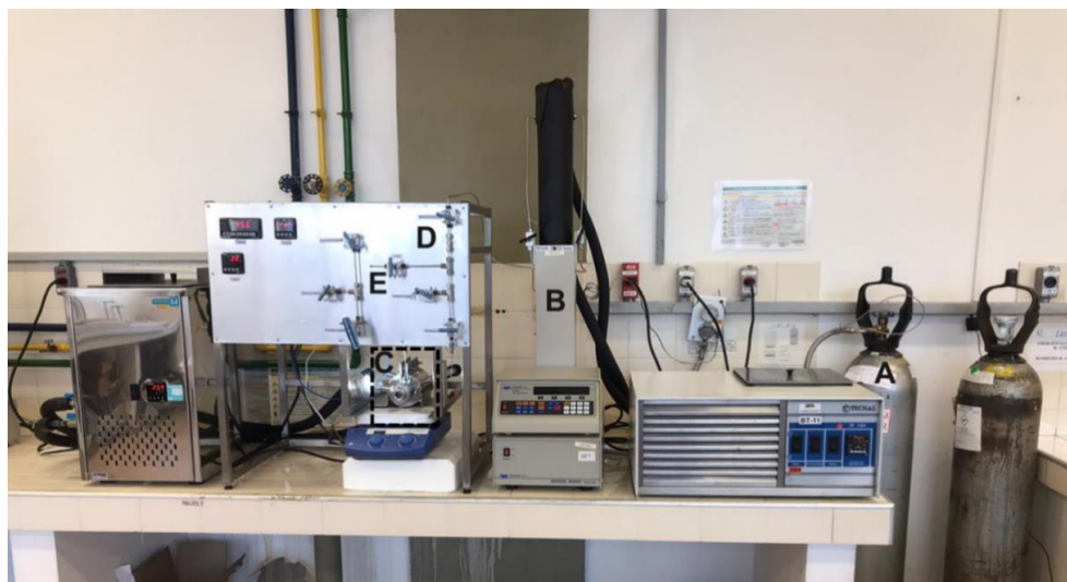
Figura 7. Vista frontal da unidade experimental de equilíbrio de fases a altas pressões
