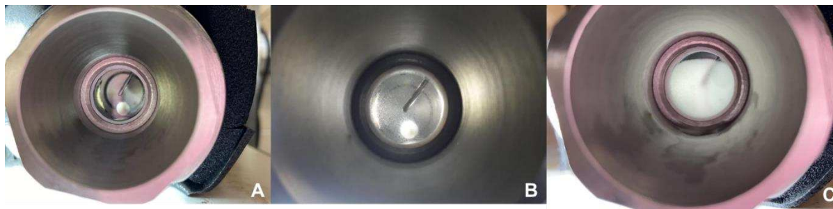
Figura 5. Vista da janela frontal da célula de pressão a 9 MPa: (A) ChCl:ETGLY líquido na temperatura de 30 °C; (B) transição sólido-líquido na temperatura de 26,9 °C; (C) ChCl:ETGLY completamente sólido na temperatura 26,5 °C.
