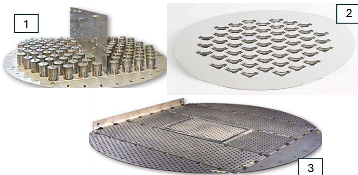
Figura 7. Tipos de bandejas. (1) Bubble cap , (2) valvulada e (3) sieve .
