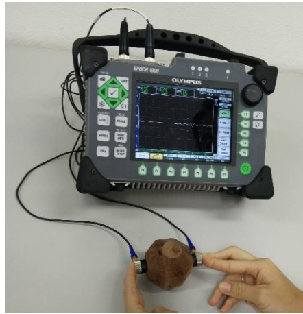
Figura 4. Ensaio de ultrassom nos poliedros para caracterização da madeira.
