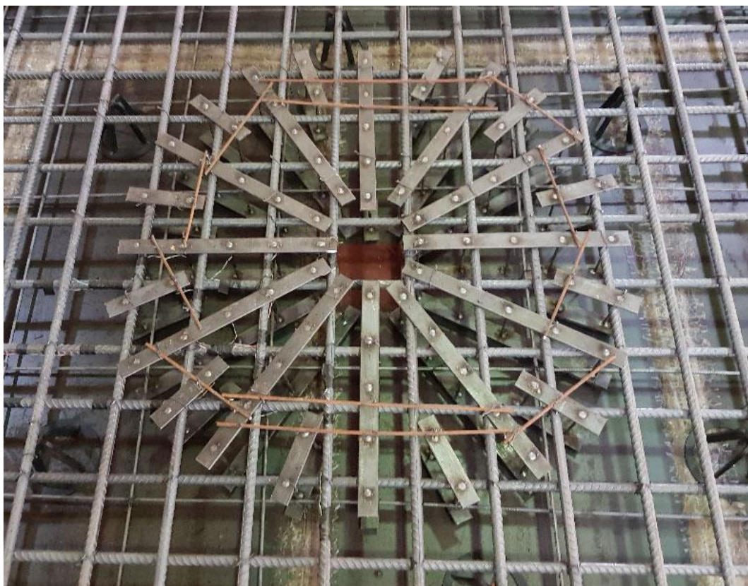
Figura 3.13: Distribuição das armaduras de cisalhamento L50C.
