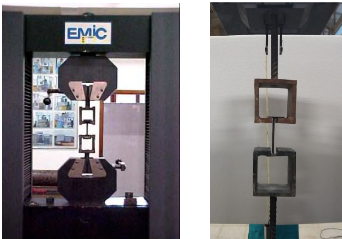
Figura 3.19: Sistema de ensaio da armadura de cisalhamento – verificação da solda entre a barra e chapas.
