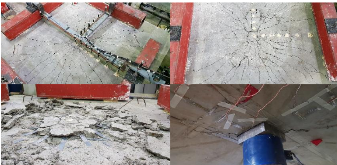
Figura 4.13: Fissuração e aspectos gerais após ruptura da laje L50C
