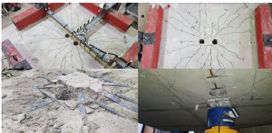
Figura 4.16: Fissuração e aspectos gerais após ruptura da laje L63F
