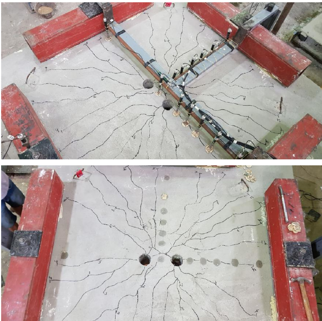
Figura 4.43: Fissuras da laje L50F antes e após a ruptura
