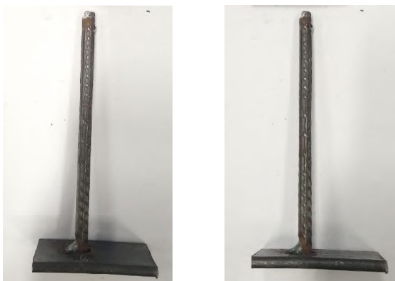
Figura 4.4: Ruptura dos “studs” próximos à solda, submetidos à tração.
