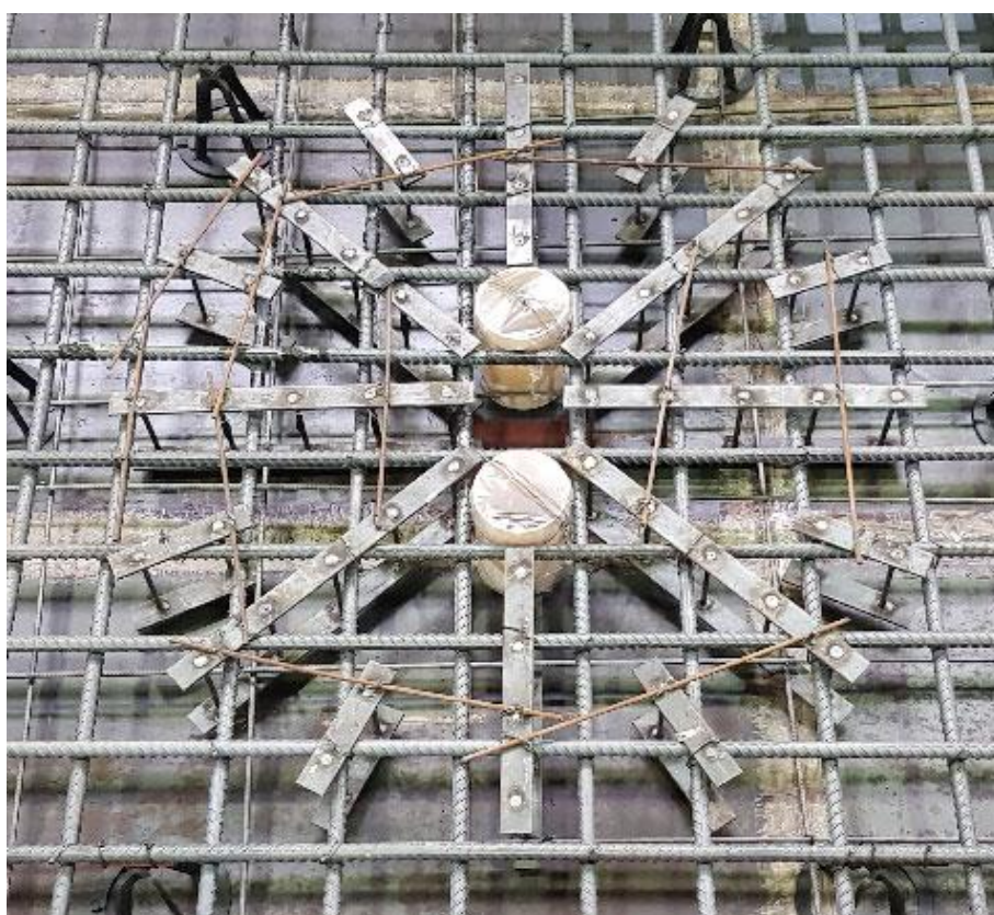
Figura 3.16: Distribuição das armaduras de cisalhamento L63F.
