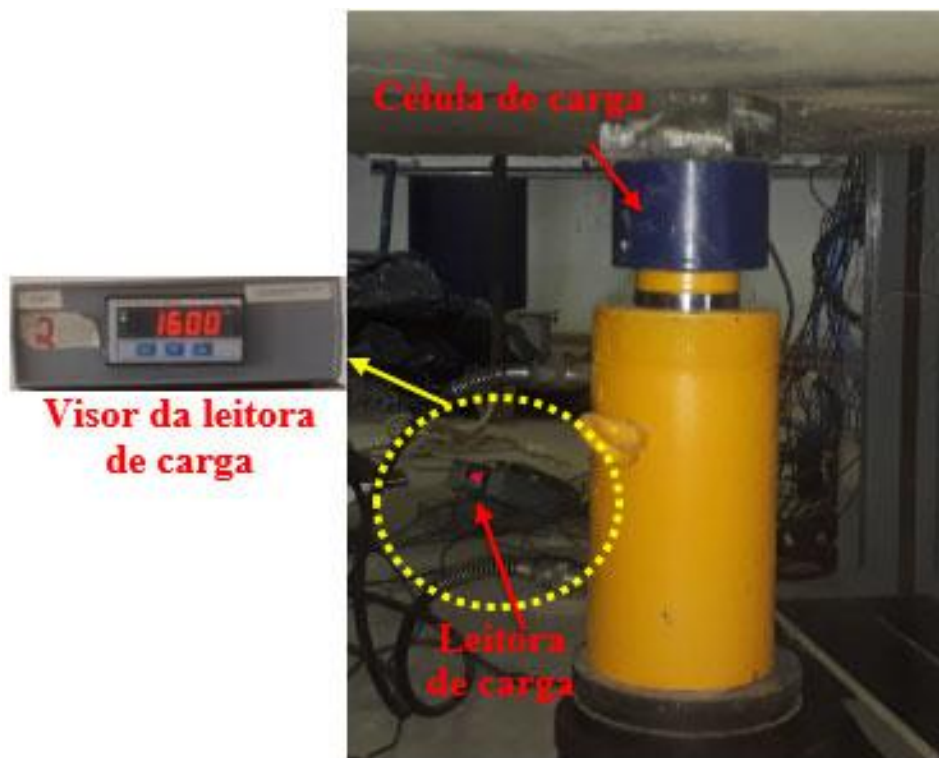
Figura 3.27: Equipamentos para aplicação e leitura das cargas.
