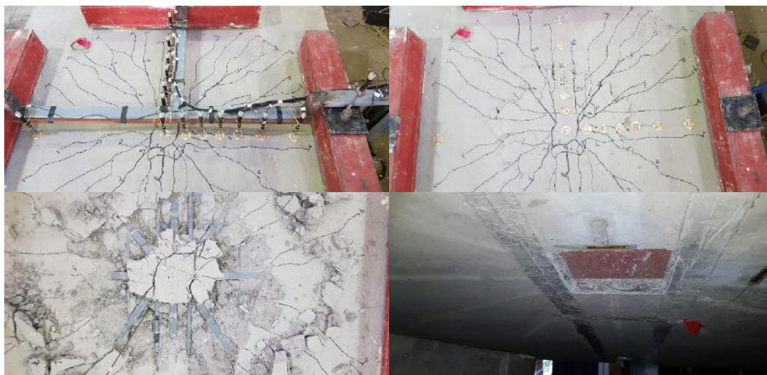
Figura 4.15: Fissuração e aspectos gerais após ruptura da laje L63C
