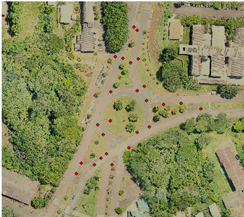
Figura 41 Distribuição dos pontos para avaliação da ortofoto voo com aeronave não tripulada área 01
