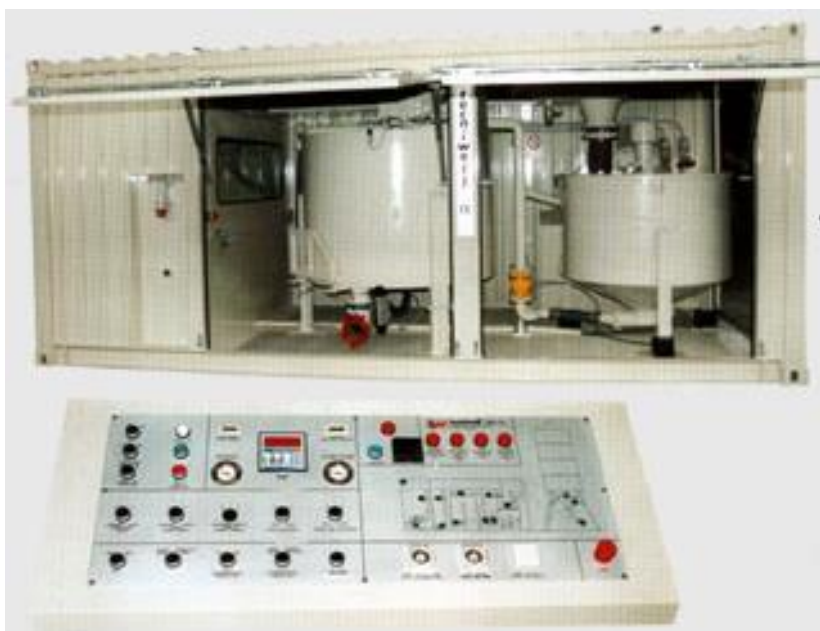
Figura 10 - Equipamento misturador da calda de cimento, (Costa Fortuna, 2015).
