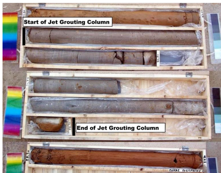
Figura 23 – Núcleos de perfuração inclinada (Obra no metrô Thessaloniki Metro, dezembro 2013. Adaptado de Kimpritis et. Al 2017)
