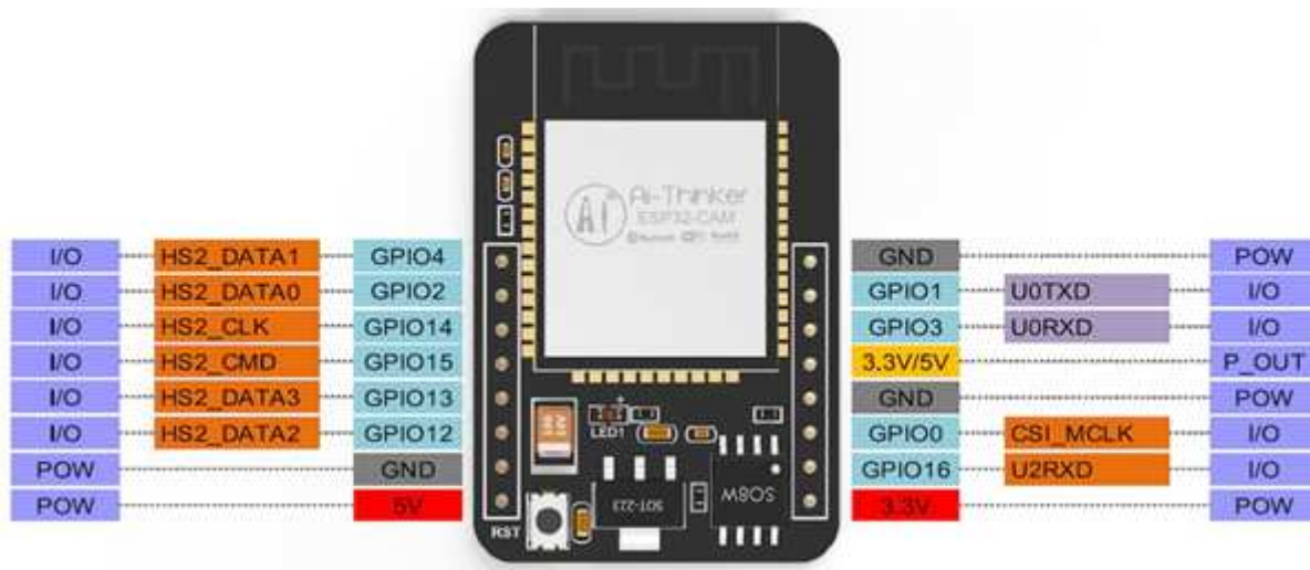
Figura 2.12: Diagrama de pinagem ESP32-CAM
