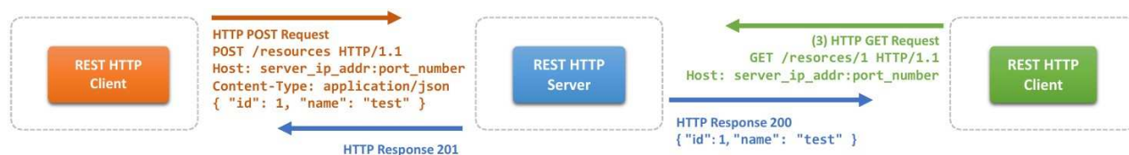
Figura 2.3: Esquema de requisições HTTP ao servidor
