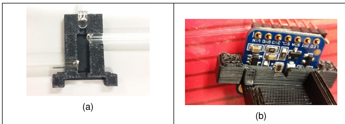
Figura 28 - Registro fotográfico do sensor impresso pela técnica de manufatura aditiva
