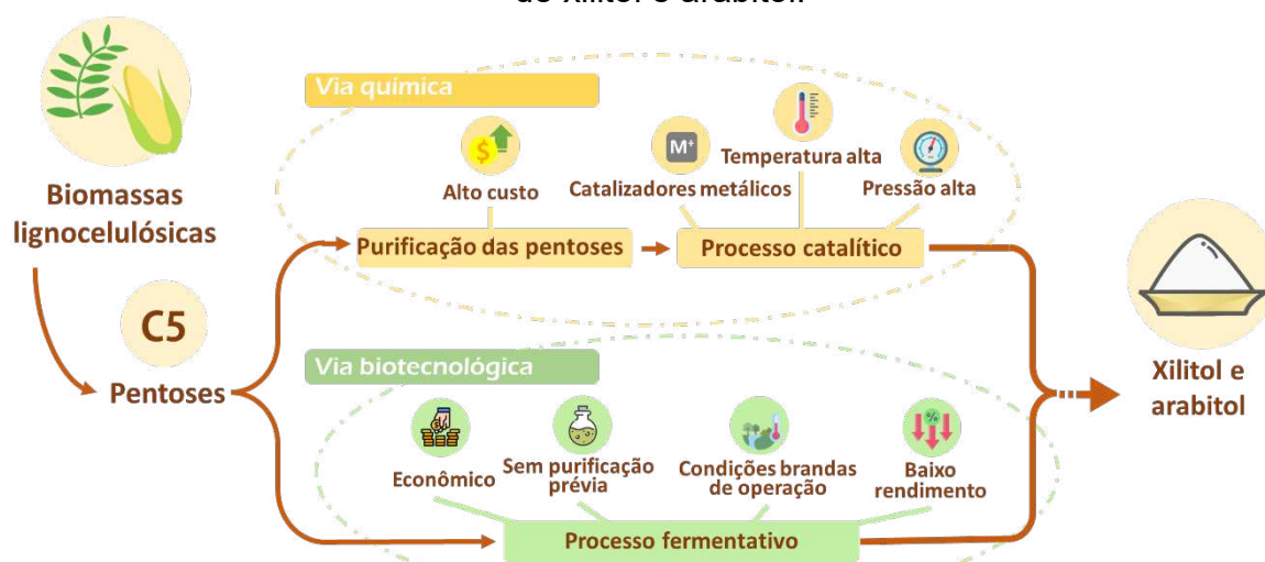
Figura 9. Esquema comparativo entre as vias química e biotecnológica de produção de xilitol e arabitól.
