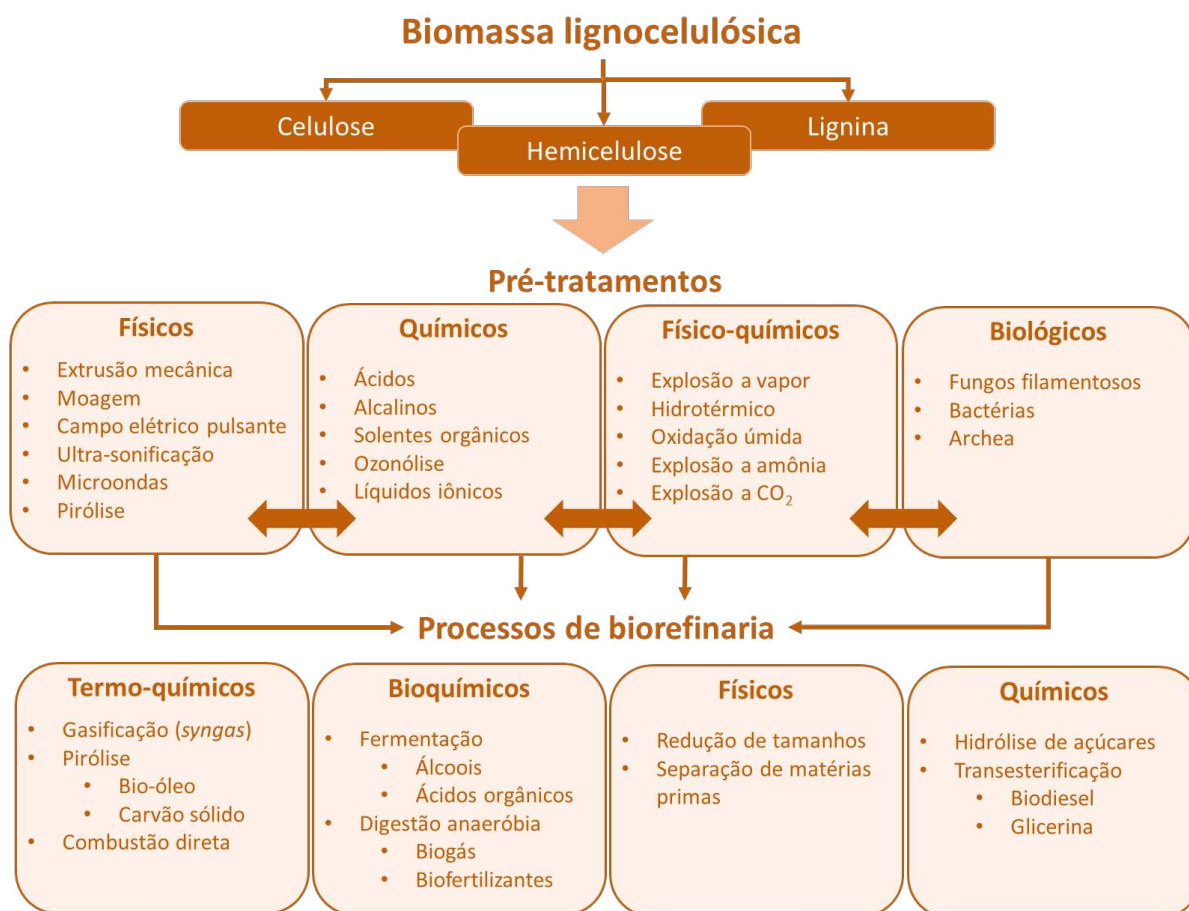
Figura 3. Visão geral dos diferentes pré-tratamentos que podem ser aplicados e produtos que podem ser obtidos a partir da biomassa lignocelulósica.
