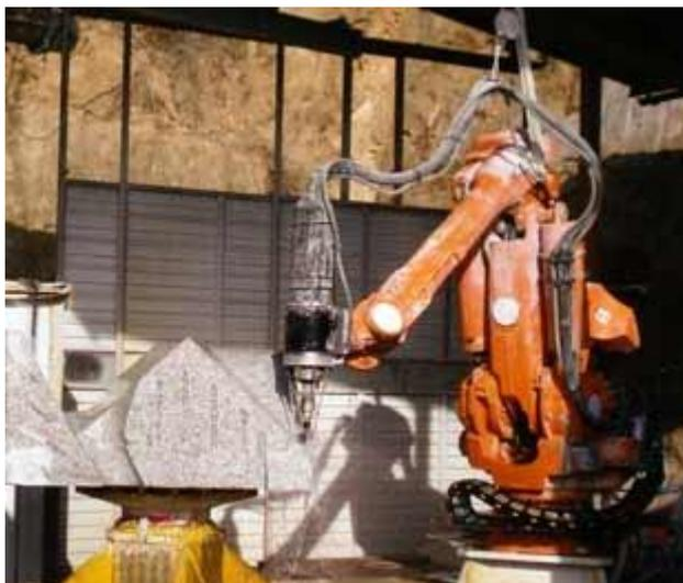
**Figura 26 – Braço robótico realizando corte em pedra**
