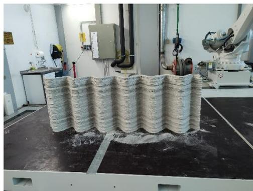
**Figura 152 – Robô usado na impressão aditiva e teste de impressão – TUM**
