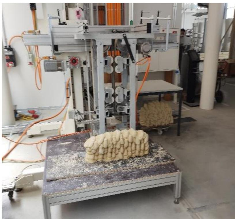
**Figura 151 – Impressão 3D por impacto no NCCR Digital Fabrication - ETHz**
