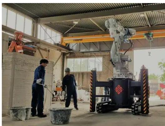
**Figura 41 – Braços robóticos com associação a veículo autônomo**
