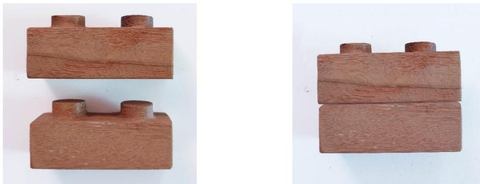
**Figura 109 – Montagem manual de encaixe por pinos com folga de 1mm**
