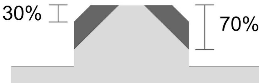
**Figura 112 – Variação das superfícies inclinadas no encaixe por pinos**
