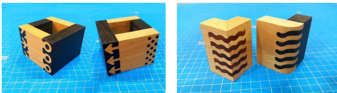
Figura 98 – Encaixes adaptados à fabricação digital
