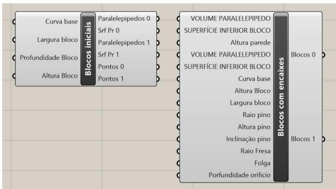
Figura 133 – Componentes para geração das peças com encaixe por pinos
