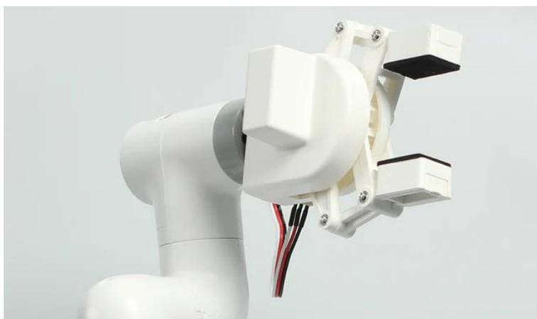
**Figura 84 – Garra (gripper adaptativo) da Elephant Robotics**
