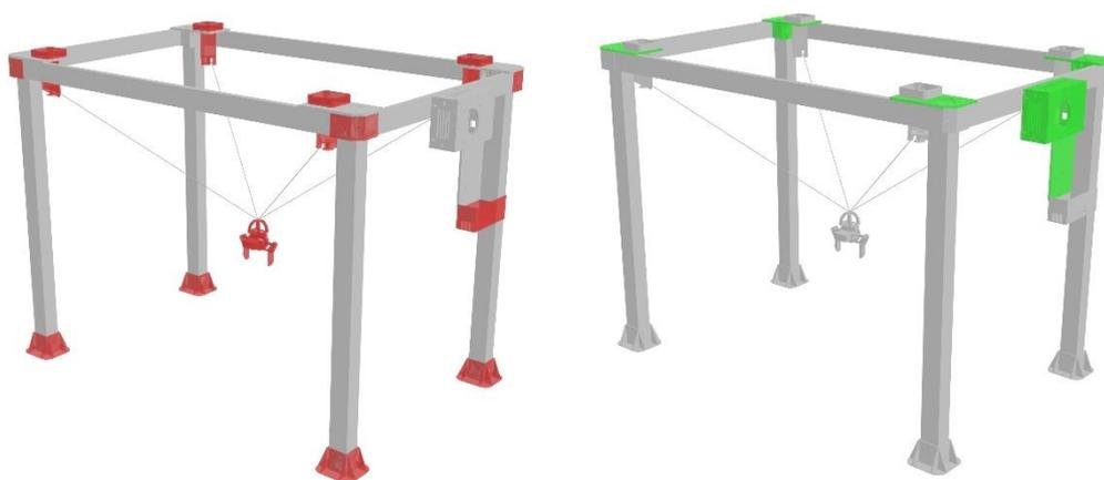
**Figura 68 – Componentes do cablebot destacadas em vermelho (impressão 3D) e verde (corte a laser)**
