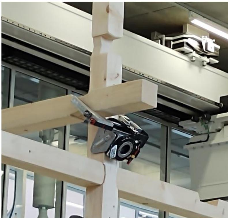
**Figura 150 – Prensa pneumática utilizada na montagem - ETHz**
