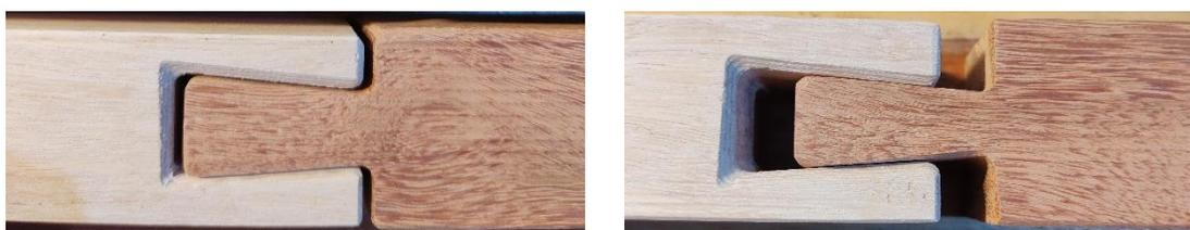
**Figura 122 - Deslocamentos no encaixe rabo-de-andorinha com tolerância de 0,5 e 1,5mm**
