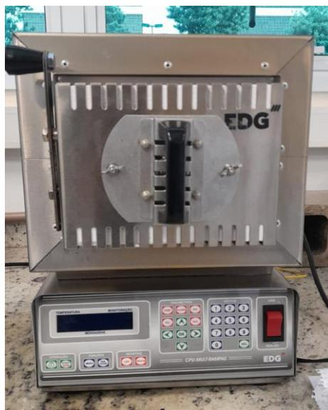
Figura 3.3 - Forno mufla resistivo.
