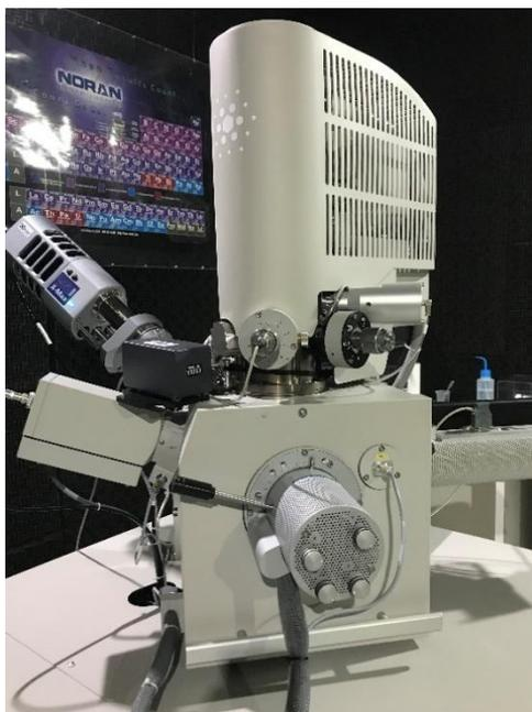
Figura 3.5 - Microscópio eletrônico de varredura, FEI Inspect F50.
