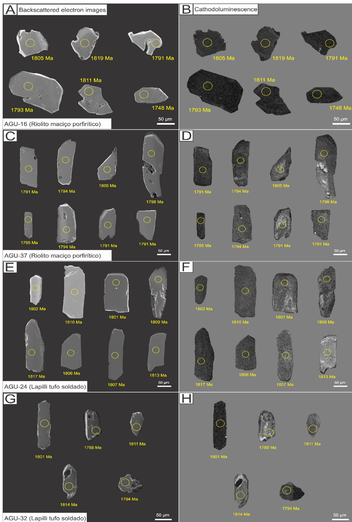
Figura 18: A, C, E e G) Imagens de BSE; B, D, F e H) Imagens de catodoluminescência de cristais de zircão das amostras analisadas. Tamanho do Spot de 25 µm.
