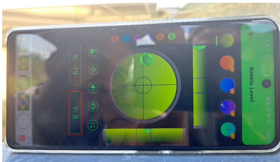
Figura 5.11: Medição do ângulo de inclinação dos arranjos fotovoltaicos utilizando um aplicativo de nível digital em smartphone.
