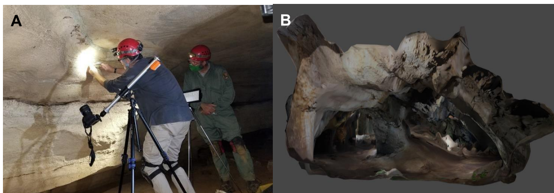
Figura 8 - Levantamento fotogramétrico de cavidade natural subterrânea (A). Modelo 3D após processamento fotogramétrico da nuvem de pontos (B). Fonte: Wood e Toomey, (2020); Pukanská et al. (2020).
