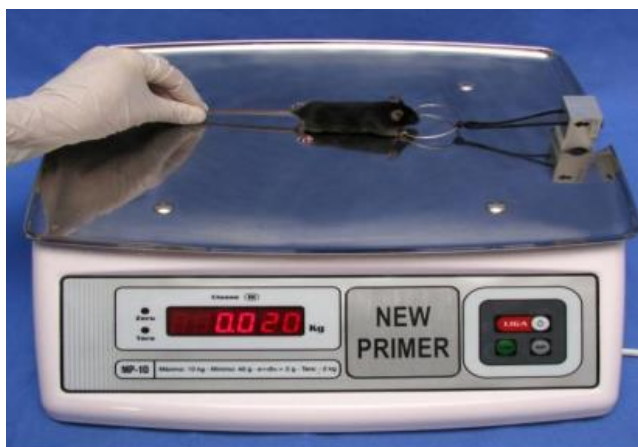
Figura 7: Aparelho Gripstrentgh Newprimer® utilizado para medir força muscular.
