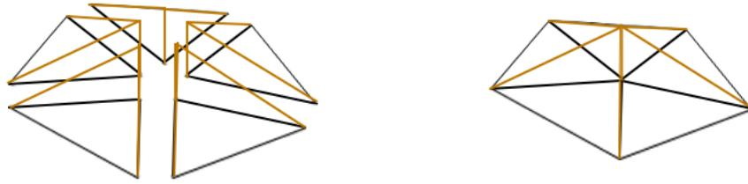
Figura 4 – Funções de forma locais em  $P_1(K)$  sobre elementos triangulares (lado direito) e seu acoplamento em  $\mathcal{U}_{h,1,\Delta}$ .
