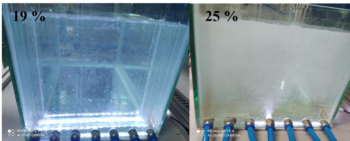
A Figura 5.7 ilustra o momento em que a geração de microbolhas é o suficiente para que ocorra a flotação de forma satisfatória do material particulado disperso na água. Na parte superior está a camada de sujeira acumulada e logo abaixo está a água clarificada.
