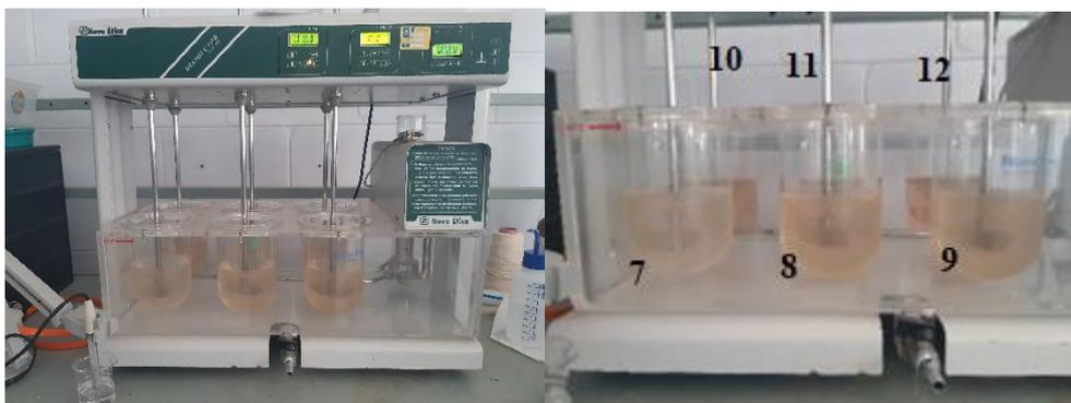
Logo, para cada litro de água bruta a ser tratada deve ser adicionado 6 mL de Tanino SG<sup>®</sup> a 5 % v/v e 1 mL de aluminato de sódio a 2 % v/v. Na realização dos testes na planta foi necessário diluir a solução de aluminato de sódio para 1% v/v por causa da limitação da bomba dosadora não conseguir trabalhar a baixas vazões.
