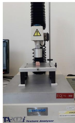
**Figura 3.** Análises instrumentais em mortadela. **a)** Espectrofotômetro portátil Minolta Chroma Meter 508D e **b)** Texturômetro Texture Analyser TA-XT2i
