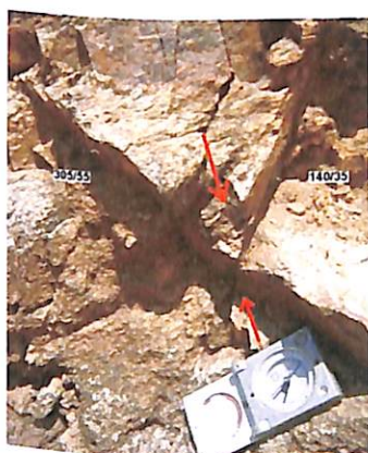
Figura 5.7: Ponto 82. Juntas conjugadas. Setas vermelhas indicam sentido do tensor principal ( \sigma_1 )
