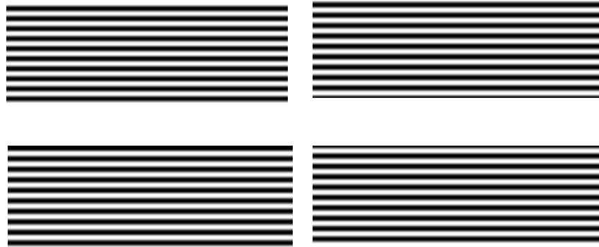
Figura 7: Grades de linhas paralelas para *moiré* por phase-shifting por retículos, deslocadas de  $90^\circ$  entre si. Fonte: (LINO, 2008)
