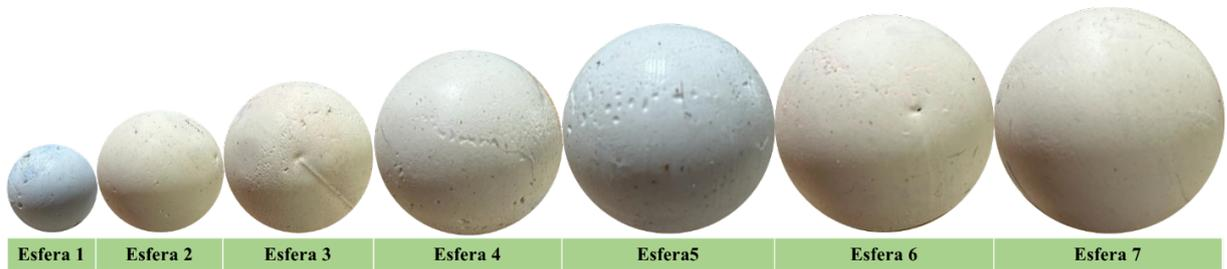
Figura 13: Corpos de prova confeccionados em silicone, por injeção em matrizes também de silicone desenvolvida pelo discente e suas respectivas dimensões e pesos em tamanho real. Fonte: o Autor
