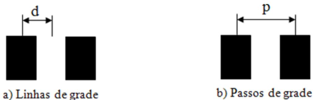
Figura 3: Definição dos termos de grade com relação a: a) Linha de grade e b) Passo de grade. Fonte: (GAZZOLA, 2011)
