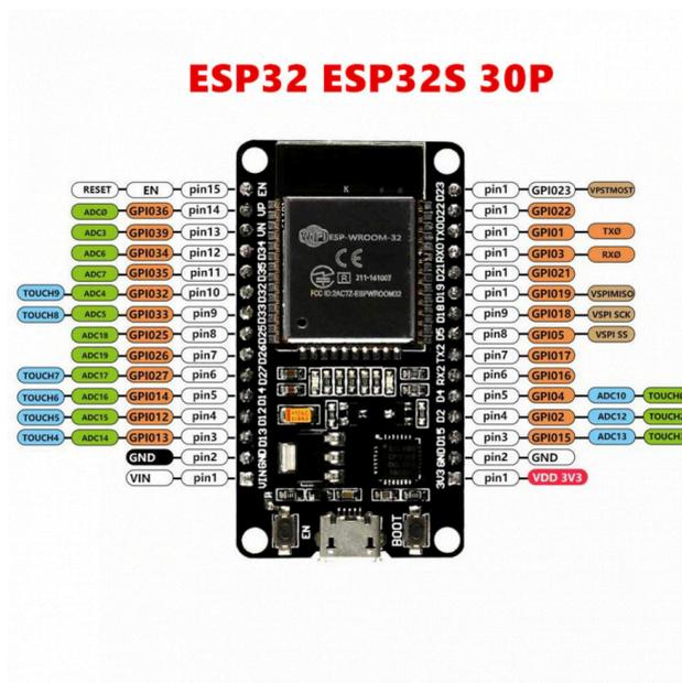
Fonte: HU INFINITO. [Módulo Wifi NodeMCU ESP-32 + Bluetooth]. Disponível em
