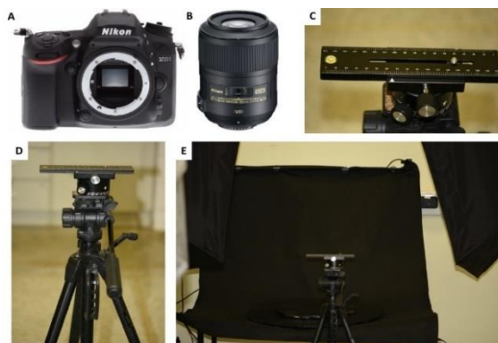
Figura 4: Kit de configuração de fotografia A: Câmera Nikon DSLR D7200. B: Lente AF-S DX Micro NIKKOR 85mm f/3.5G ED VR. C: Barra deslizante da câmera DSLR. D: Tripé (Weifeng WF-3716) conectado à barra deslizante da câmera DSLR. E: Estúdio de Fotografia. Um conjunto de lanternas (Atek AT242D Digital Flash 140 Plus) conectadas a tripés (Atek AT932BAN Black III) é utilizado para remover as sombras. Um fundo escuro é a maneira mais simples, fácil e artística de isolar o objeto.
