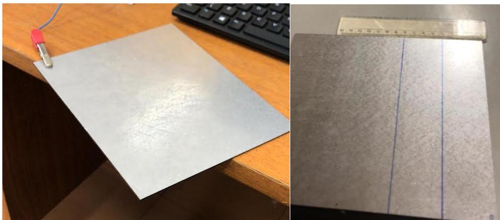
**Figura 37:** Chapas de aço 22MnB5 como recebidas revestidas com Al-Si.
