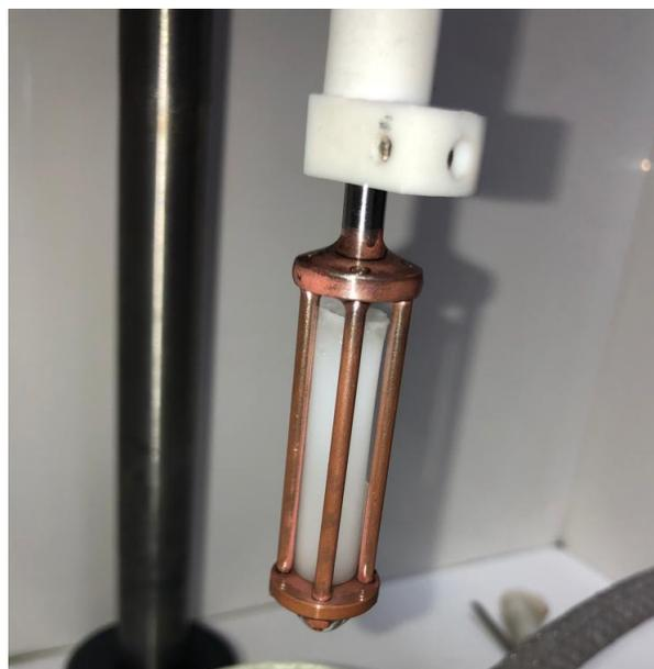
Figura 38: Fotografia da haste de aço inoxidável com o PAam após um experimento com tensões acima de 1,5 V.
