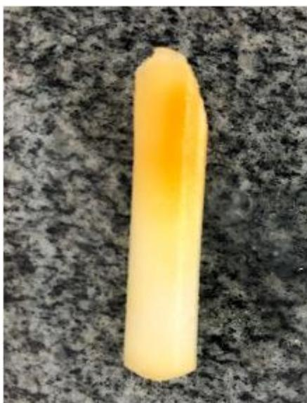
Figura 20: PAam após o processo de eletroadsorção do  $\text{Fe}^{2+}$  em leito fixo
