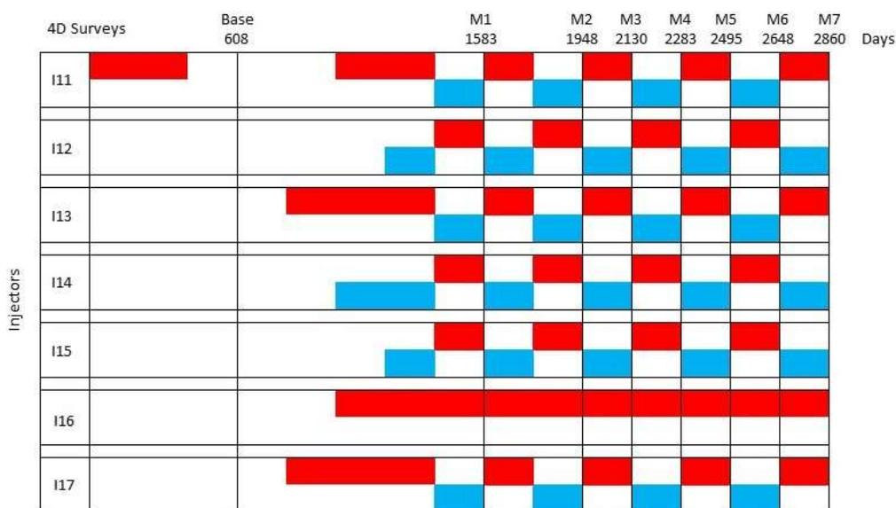
Figura 7: Ciclos de WAG e período de aquisição de cada levantamento modelado (uma base e sete monitores). A cor azul representa o ciclo de injeção de água e a cor vermelha o ciclo de injeção de gás.
