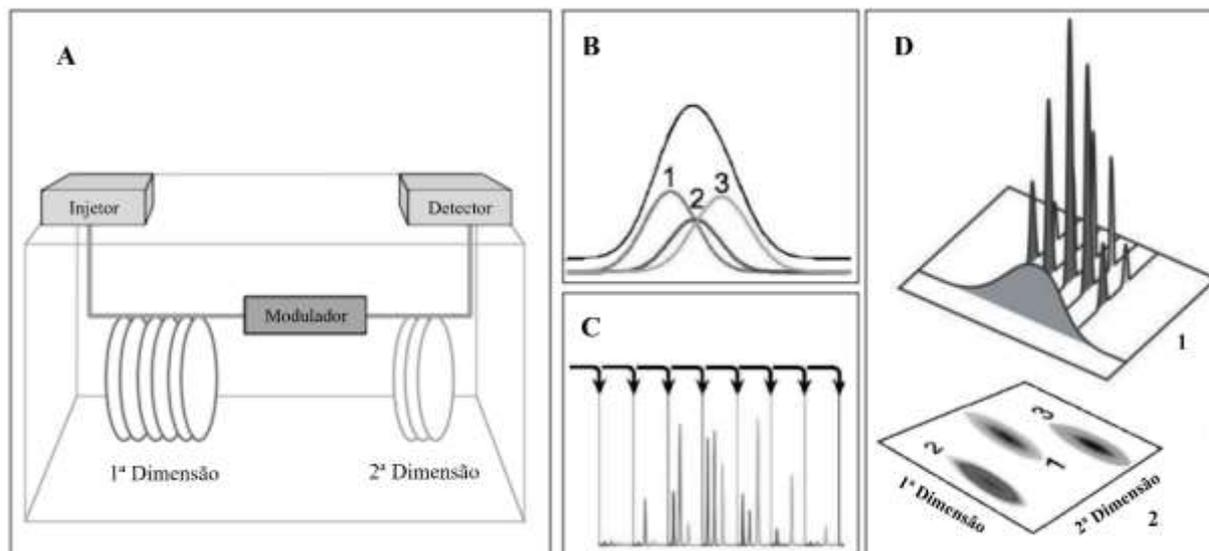
**Figura 7:** Instrumentação de GC×GC (A) e princípio de modulação (B, C e D). Adaptado da referência<sup>120,121</sup>.
