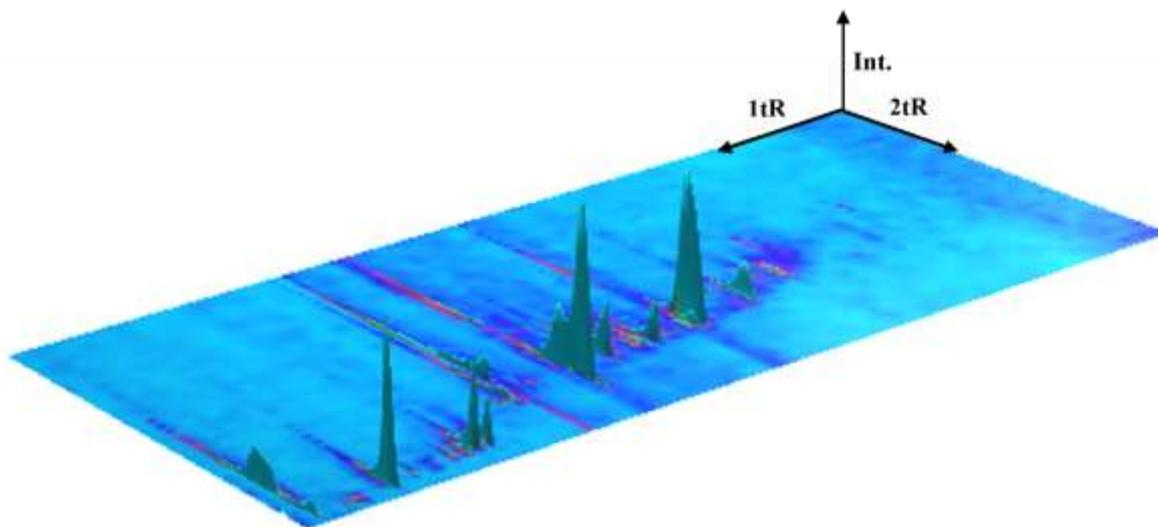
**Figura 8:** Visualização <sup>3</sup>D obtida, com o terceiro eixo (z) representando a intensidade do pico de um cromatograma obtido por separações GC×GC-MS. (Próprio autor)
