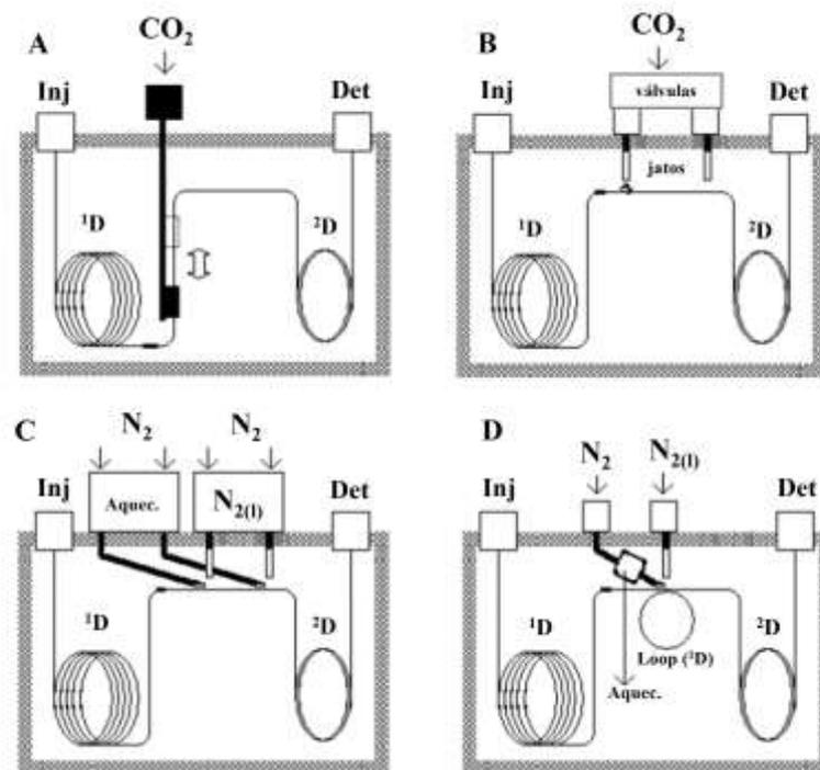
**Figura 9:** Diagramas de moduladores criogênicos. (A) LMCS, (B) modulador criogênico de duplo jato, (C) modulador com dois jatos quentes e dois jatos frios, (D) modulador com um jato quente e um jato frio. "Inj." refere-se ao Injetor, "Det." ao Detector, e "aquec." ao aquecimento. Adaptado da referência<sup>121</sup>.
