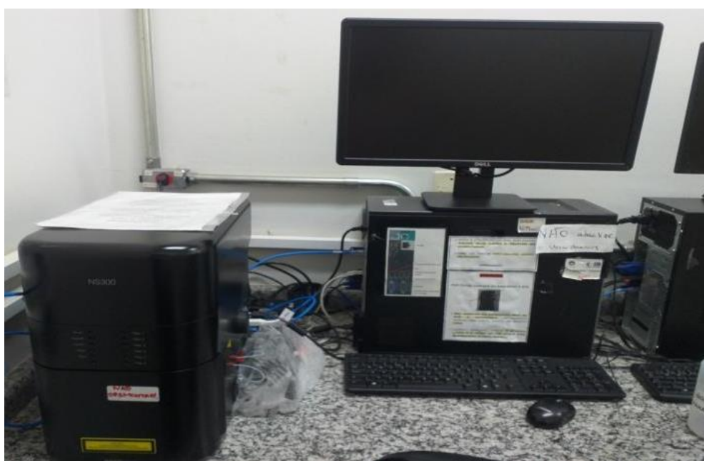
Figura 9 - Equipamento NanoSight NS300 Malvern, utilizado para as análises de NTA.
