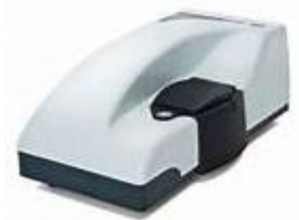
Figura 8 - Equipamento de espectroscopia de correlação por fótons (DLS) ZetaSizer Nano ZS 90.
