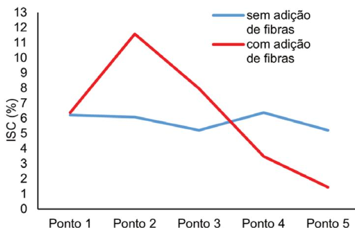
**Figura 10.** Valor do ISC, em porcentagem, dos pontos compactados, para uma pressão padrão de 6,90 MPa.
