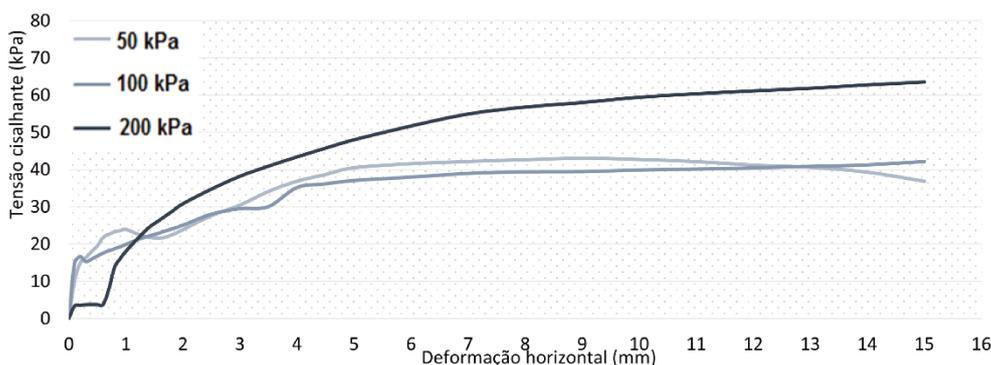
**Figura 13.** Gráfico de “tensão cisalhante *versus* deformação horizontal” para o solo sem reforço.
