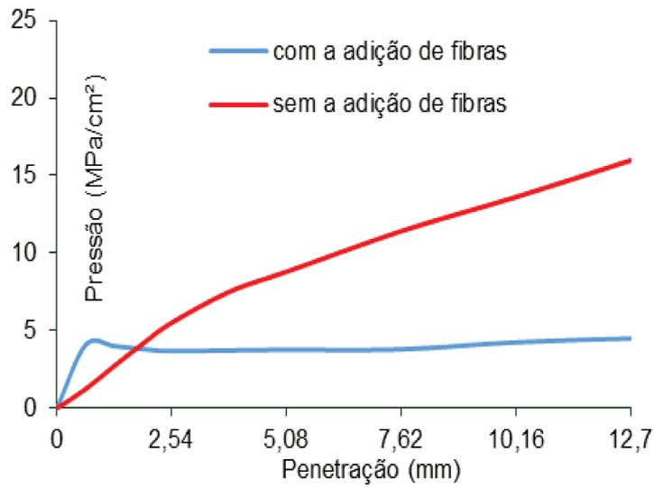
**Figura 7.** Gráfico de correção do ISC para o 3º ponto, de umidade 23,6%.
