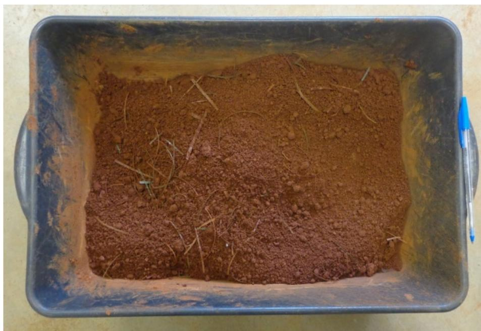
**Figura 3.** Solo utilizado no estudo com a adição das fibras de garrafas PET.
