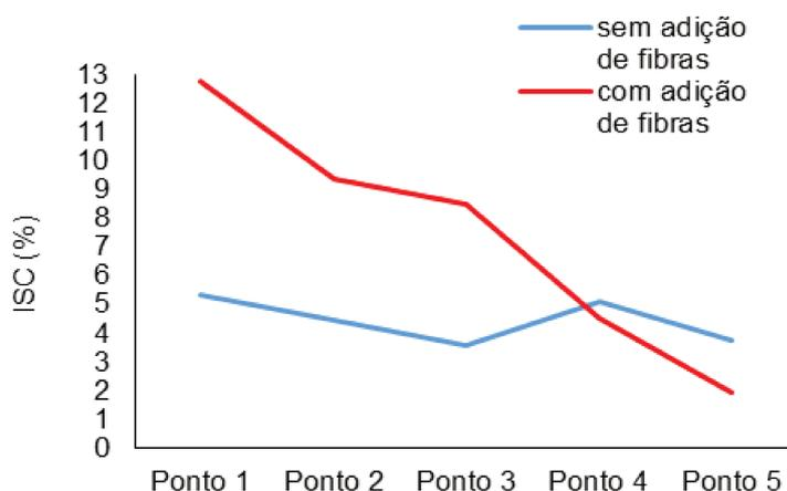
**Figura 11.-** Valor do ISC, em porcentagem, dos pontos compactados, para uma pressão padrão de 10,35 MPa.
