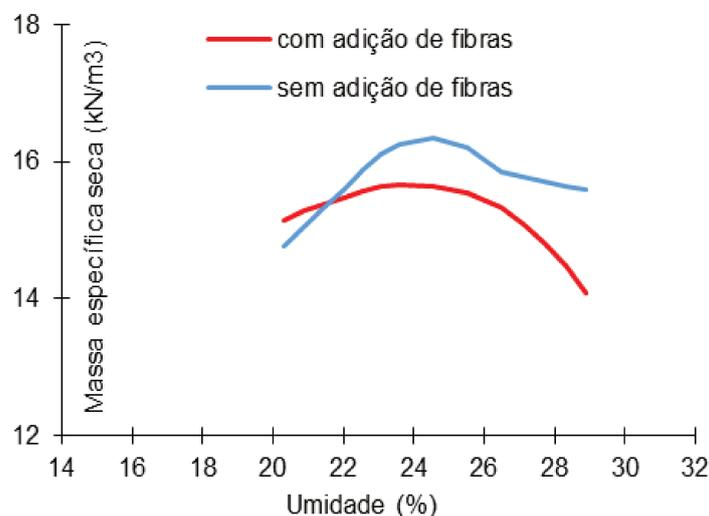
Figura 4 - Curvas resultantes do ensaio de compactação.
