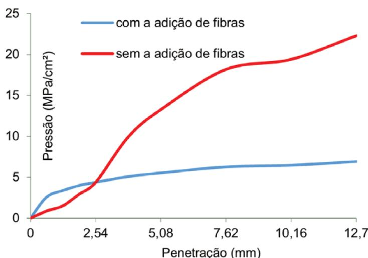
**Figura 5.** Gráfico de correção do ISC para o 1º ponto, de umidade 20,3%.
