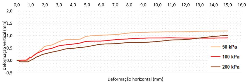
Figura 16 - Gráfico de “deformação vertical *versus* deformação horizontal” para o solo reforçado.
