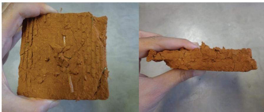
**Figura 12.** Corpo de prova, moldado com solo reforçado, cisalhado com uma tensão aplicada de 100 kPa.
