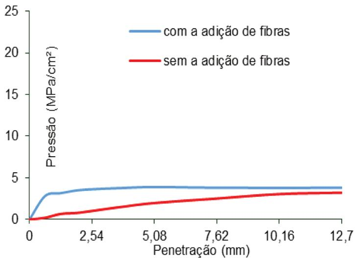
**Figura 9.** Gráfico de correção do ISC para o 5º ponto, de umidade 28,3%.
