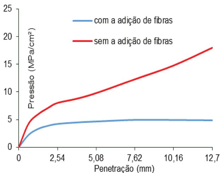
**Figura 6 -** Gráfico de correção do ISC para o 2º ponto, de umidade 22,0%.
