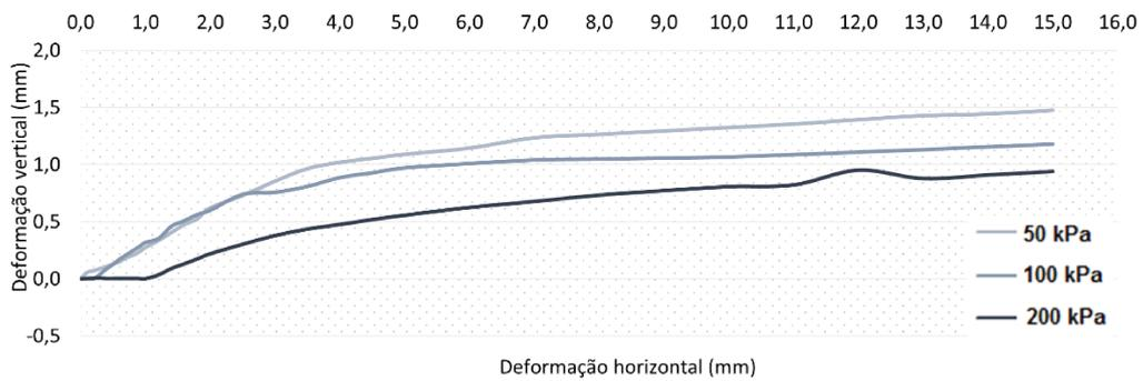
Figura 15. Gráfico de “deformação vertical *versus* deformação horizontal” para o solo sem reforço.
