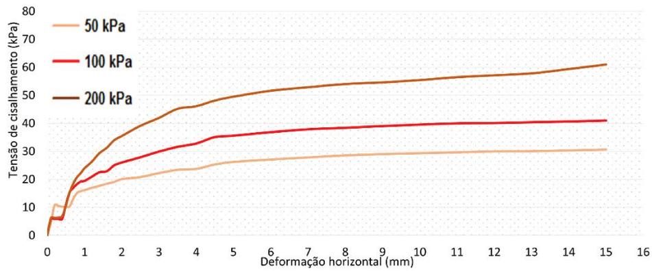
Figura 14. Gráfico de “tensão cisalhante *versus* deformação horizontal” para o solo reforçado.
