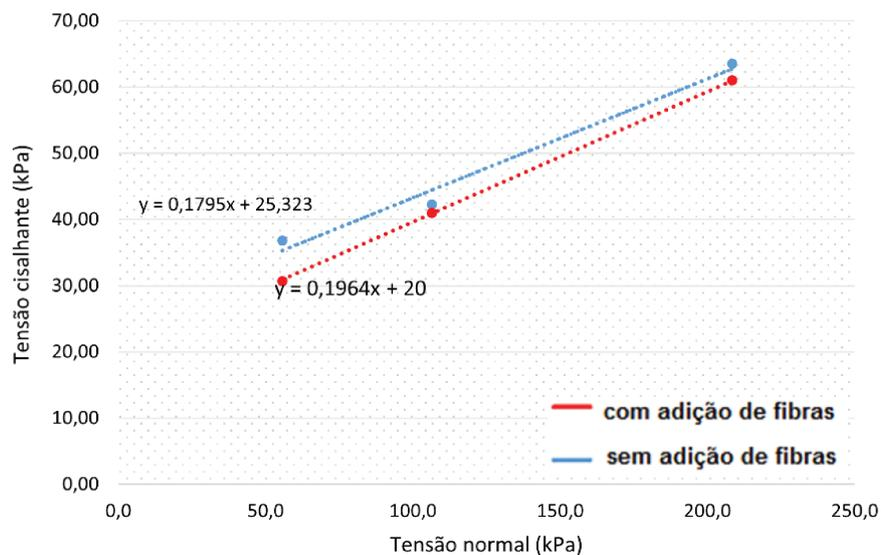
Figura 17 - Gráfico de "tensão cisalhante *versus* tensão normal". Em azul: solo sem reforço; em vermelho: solo reforçado.
