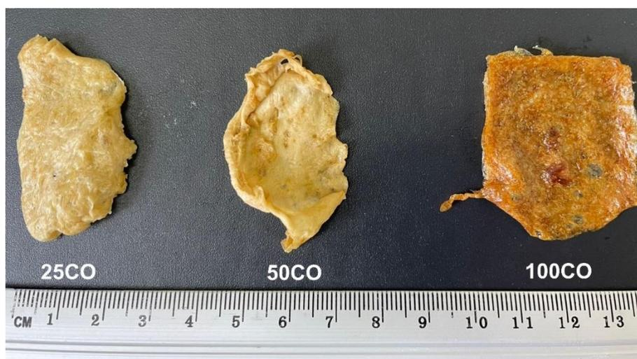
**Figura 2.** Imagem macroscópica das membranas de Látex/PVA nas concentrações de 25 mg/mL (25CO), 50 mg/mL (50CO) e 100 mg/mL (100CO).
