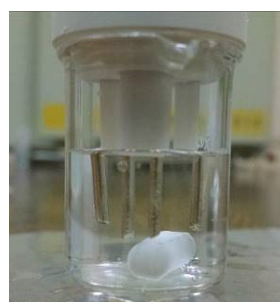
Figura 2 – Eletrodos mergulhados na solução ácida, pode-se ver a barra magnética no fundo do béquer
