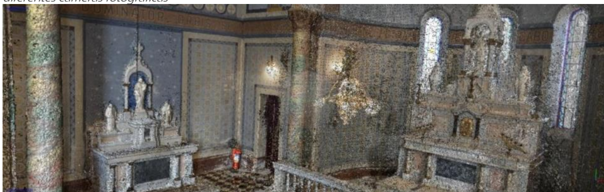
Figura 28 - Nuvem de pontos do interior da Capela São Pedro, gerada através de imagens obtidas a partir de diferentes câmeras fotográficas
