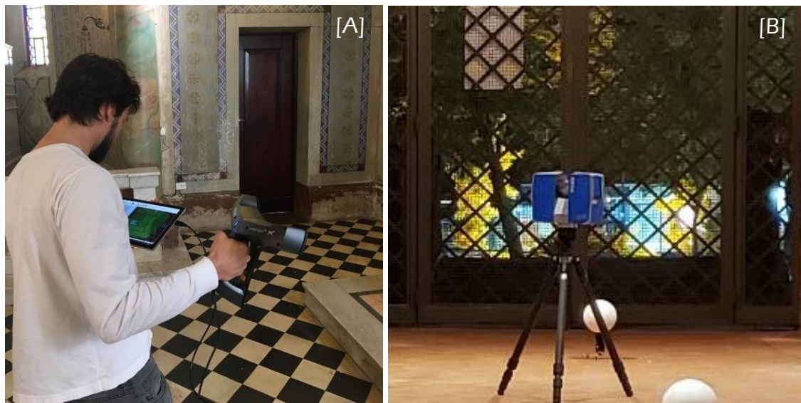
Figura 6 - Captação de nuvem de pontos utilizando escâner à laser.
