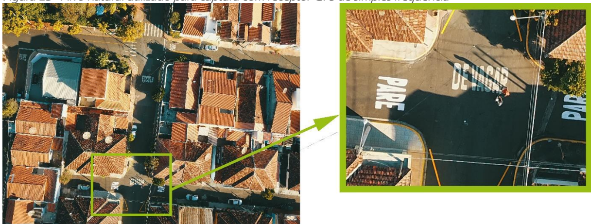
Figura 23 - Alvo natural utilizado para captura com receptor GPS de simples frequência
