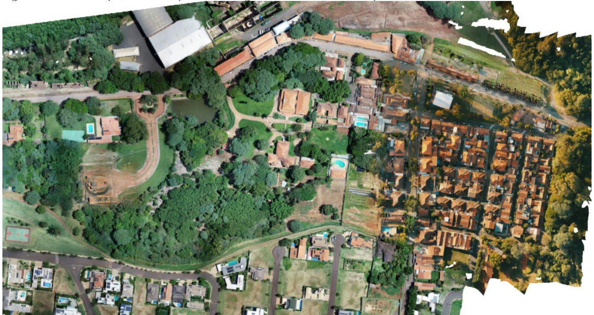
Figura 36 - Ortofoto processada a partir de imagens levantadas em dois processamentos
