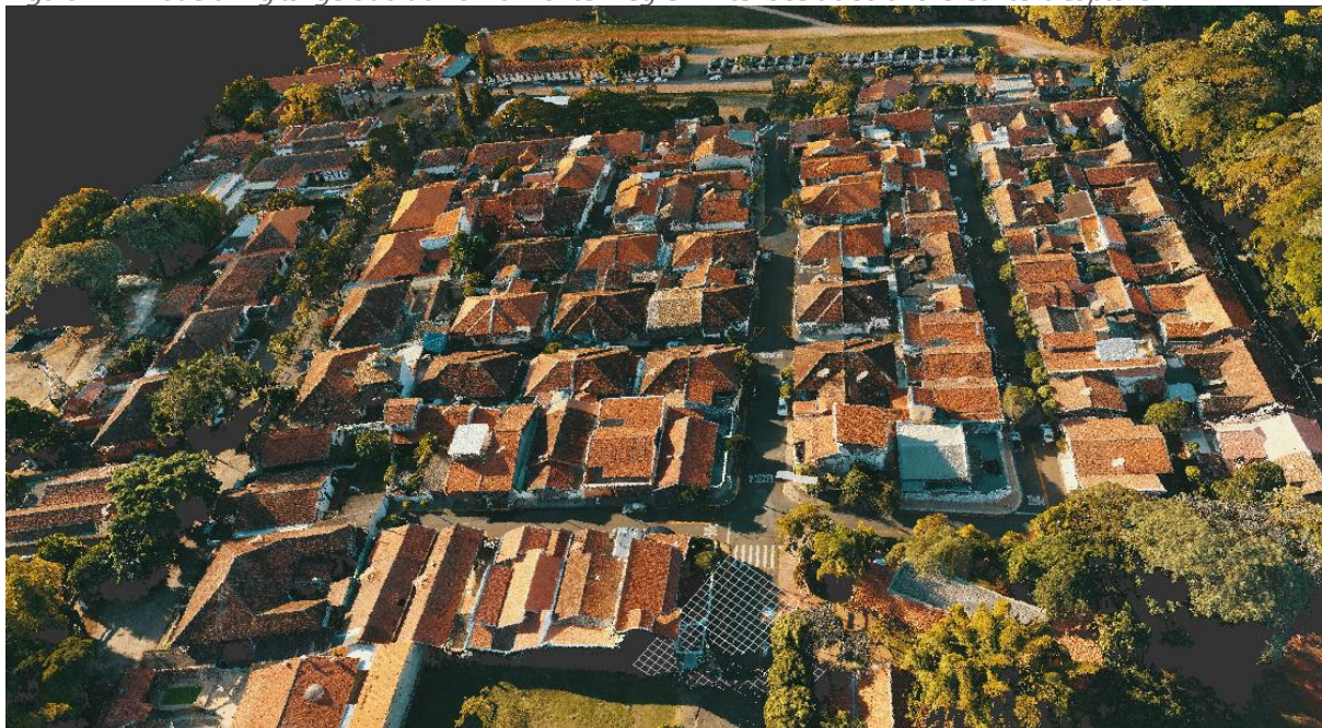
Figura 22 - Modelo Digital gerado do Bairro Monte Alegre – Interface do software Context Capture
