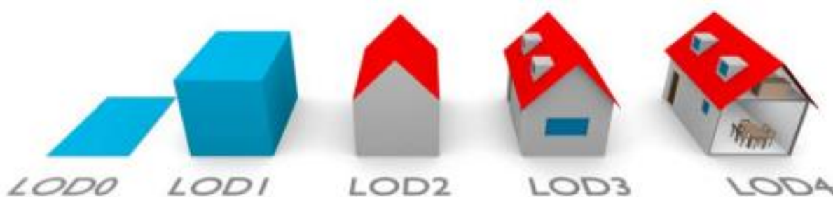
Figura 26 - Diferentes níveis de detalhamento
