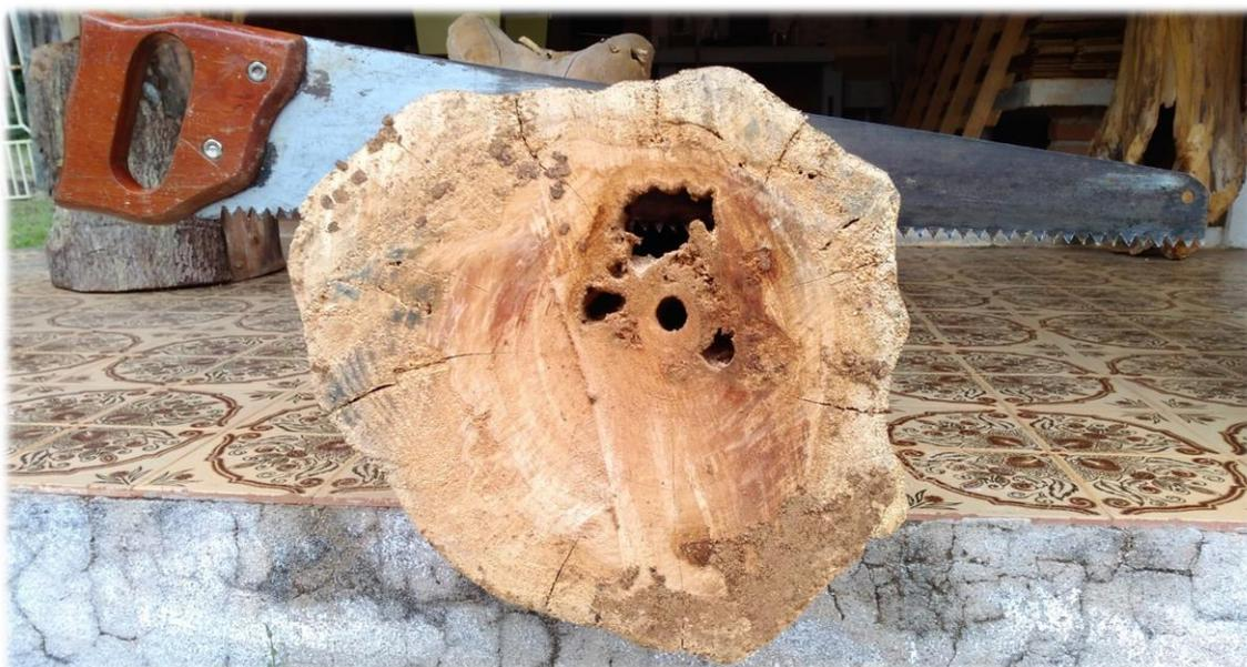
Figura 28 – Detalhe de corte realizado e orifícios causados pelas larvas de besouro.
