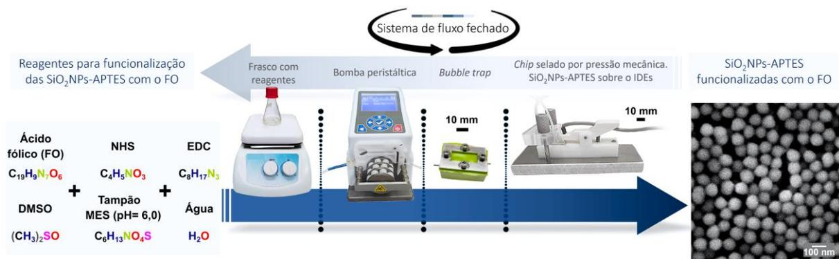
**Figura 25.** Funcionalização das SiO<sub>2</sub>NPs-APTES com FO e plataforma de detecção. Reagentes e plataforma analítica utilizados e monitoramento da funcionalização das SiO<sub>2</sub>NPs-APTES com FO, juntamente com uma imagem SEM dessas SiO<sub>2</sub>NPs-APTES funcionalizadas com FO após 12,0 h.
