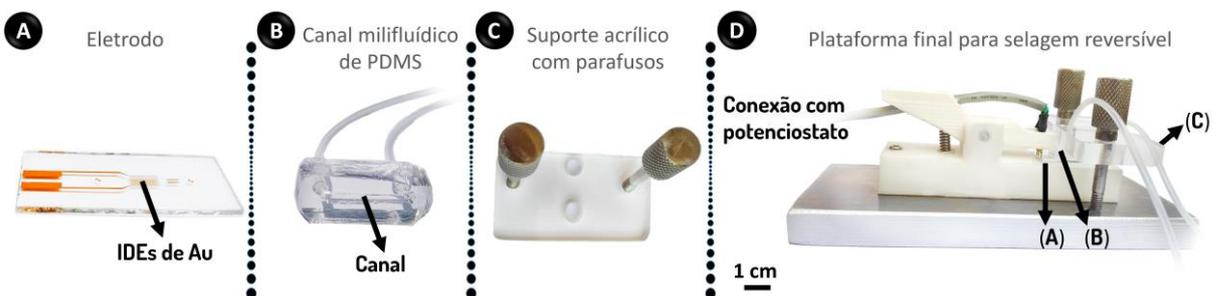
**Figura 3.** Componentes da plataforma para selagem reversível dos chips por pressão mecânica. (A) Eletrodo em vidro. (B) Substrato em PDMS com canal milifluido. (C) Suporte acrílico com parafusos. (D) Plataforma final com o dispositivo selado. Os pinos metálicos em contato com os eletrodos foram soldados a um fio para conexão elétrica com o potenciostato. As partes apresentadas nas chamadas anteriores (A, B e C) estão discriminadas nesta foto. Figura adaptada da referência 30.
