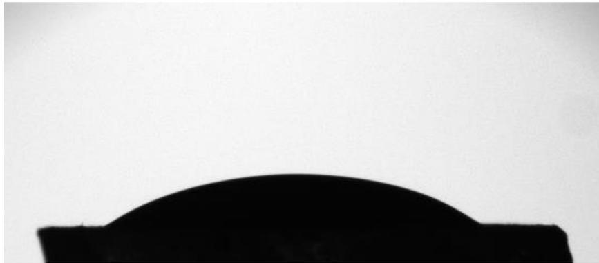
**Figura 37** - Foto característica da gota de fase oleosa (petróleo) com volume médio de  $26 \mu\text{L}$ , depositada sobre a superfície da calcita revestida com atacamita.
