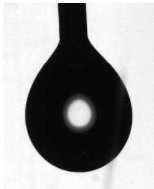
**Figura 27** - Foto característica de uma gota pendente, em ar, da fase aquosa com volume médio de 20  $\mu\text{L}$ .
