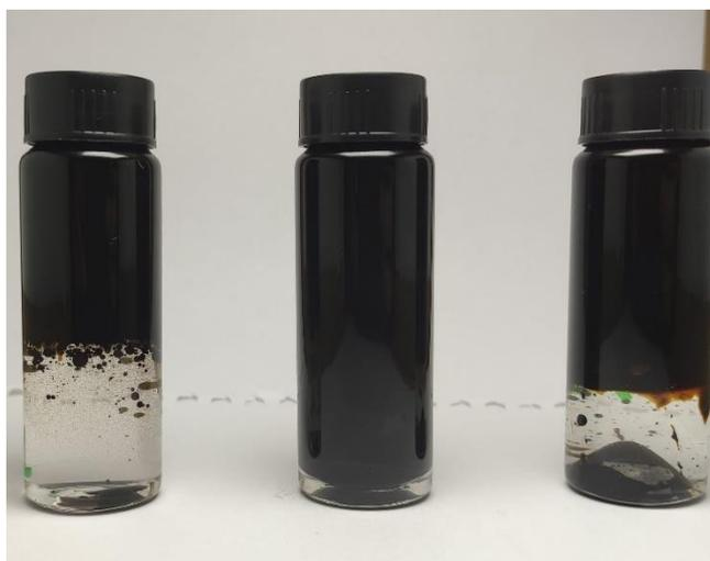
**Figura 60** - Frascos contendo as fases aquosa, oleosa e sólida. No frasco da esquerda tem-se SW e o petróleo, no frasco do meio SW, Cu(II) e o petróleo e no frasco da direita SW, Cu(II), o petróleo e a calcita.
