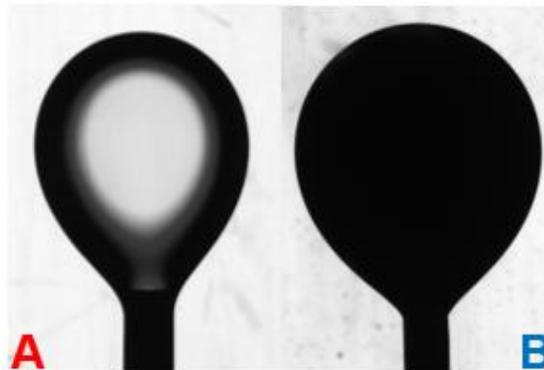
**Figura 30** - Fotos características da fase oleosa invertida: (A) gota de ácido octanóico com volume médio de 18  $\mu\text{L}$ ; (B) gota de condensado com volume médio de 25  $\mu\text{L}$ . Ambas inseridas em 15 mL de fase aquosa (salmoura e diluições).
