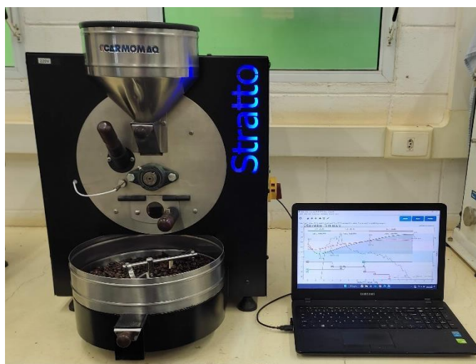
Figura 9 - Torrador Stratto® conectado ao software de torra.
