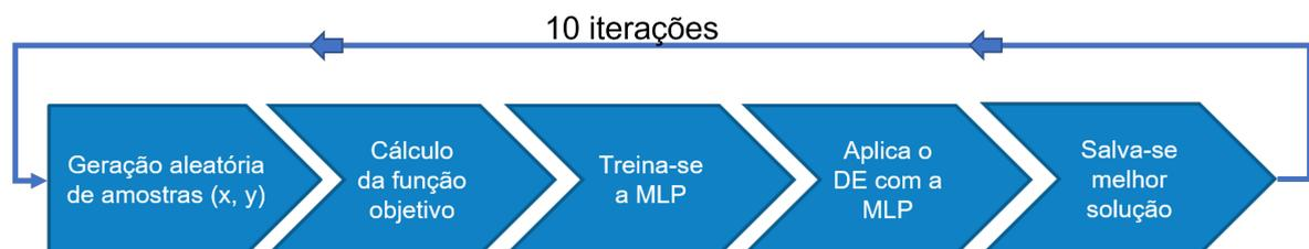
Figura 30 – Ciclo utilizado para cada iteração de um dado conjunto de amostras.
