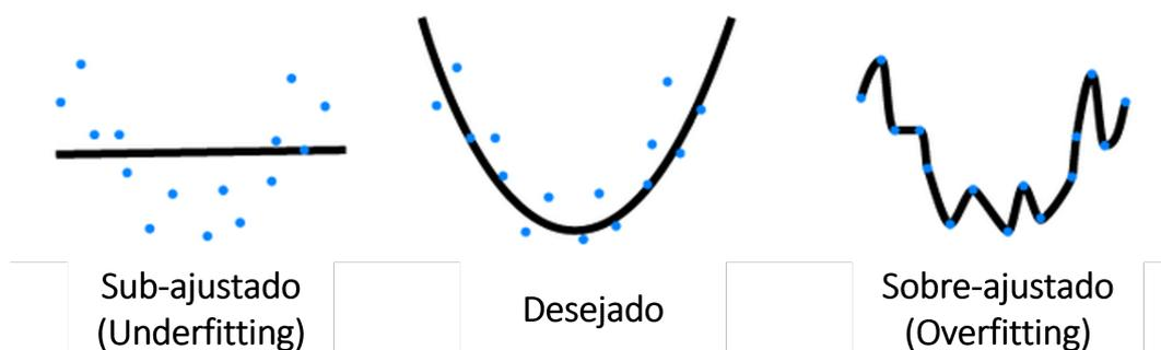
Figura 17 – Três formatos de modelos treinados de ML.
