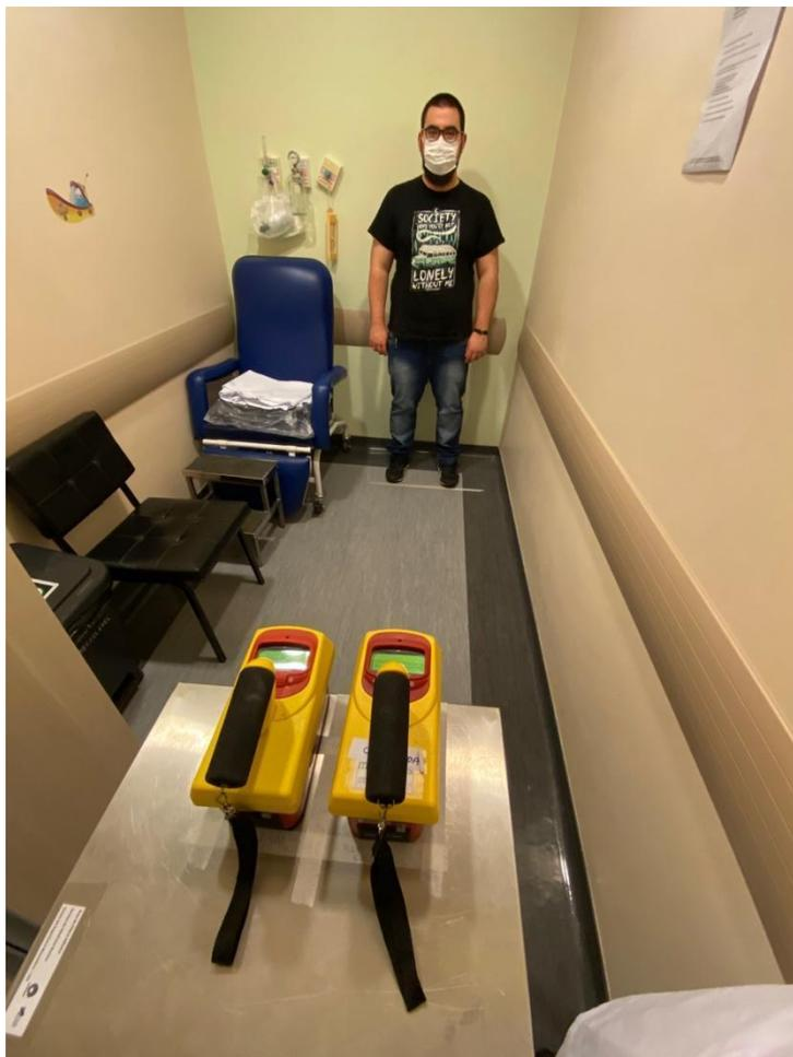
**Figura 1:** Exemplo de como as medidas eram realizadas. Paciente e detectores de radiação eram posicionados a 2 metros de distância. Marcações no chão auxiliavam o posicionamento. Obs.: Na imagem são mostrados apenas os detectores Fluke® 451B e Fluke® 451P. Após finalizada a coleta de dados com esses detectores, eles eram retirados e colocava-se no lugar os outros detectores também utilizados.
