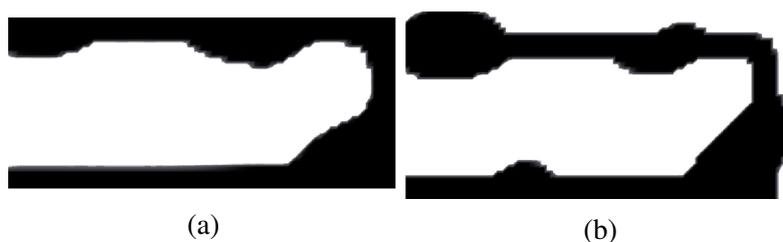
Figura 5.37 – Topologias do mecanismo dobrador de De Souza e Silva (2020). (a) Resultado usando regiões fora do domínio de projeto como ilustrado na Figura 5.36d. (b) Resultado usando regiões fora do domínio de projeto como ilustrado na Figura 5.36e.
