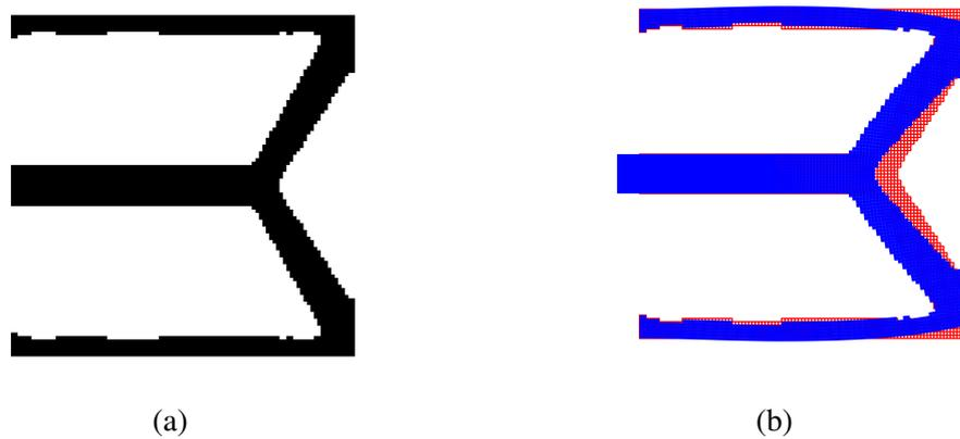
Figura 4.34 – Topologia final do mecanismo *crunching* com função objetivo  $MSE/SE$  em 30% do volume inicial. (a) Topologia em preto e branco. (b) Mecanismo estático (vermelho) e deslocado (azul) (ampliado em  $10^7$  vezes).
