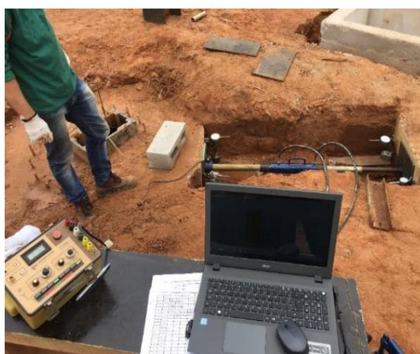
Figura 5-11 – Preparação para execução do ensaio nos tubulões, por Enggroup (2019)
