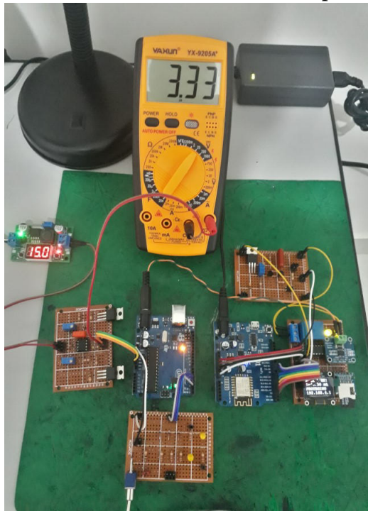
Figura 4.10: Estado de sobretensão no pino 3,3V
