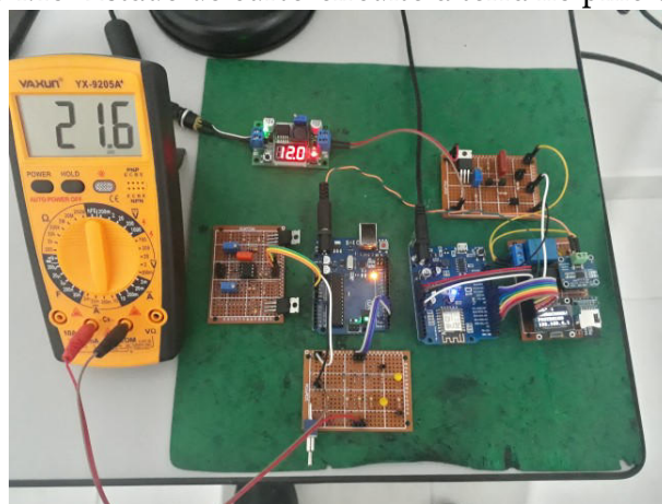
Figura 4.13: Estado de curto-circuito a terra no pino de saída
