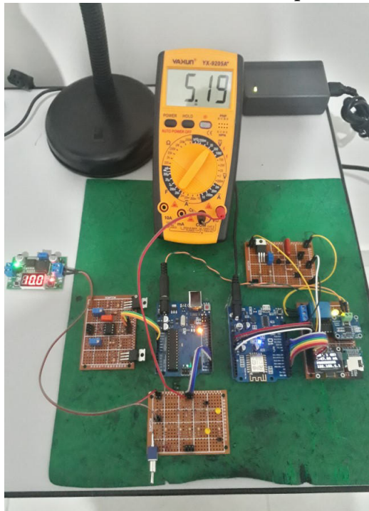
Figura 4.11: Estado de sobretensão no pino de entrada
