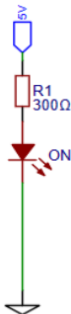
Figura 3.19: Circuito LED "On" da placa Interface
