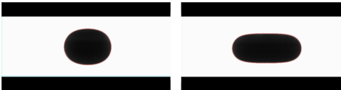
**Figura 34:** Fotos da gota de óleo no início da análise (à esquerda) e após atingir o equilíbrio entre as forças associadas à tensão interfacial e a força centrífuga (à direita).
