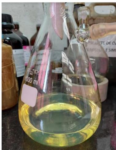
**Figura 28:** Solução contendo as frações de aromáticos e saturados obtidas após o processo de extração de resinas do Óleo A.
