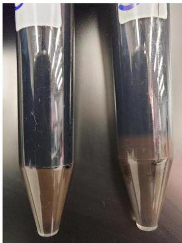
**Figura 26:** Fase aquosa separada ao fundo dos tubos após procedimento de centrifugação. Óleo A (à esquerda) e óleo B (à direita).
