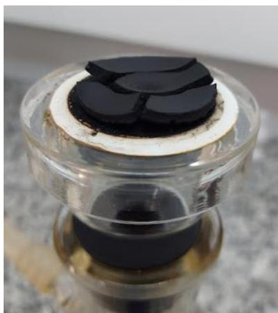
**Figura 27:** Asfaltenos do óleo A retidos na membrana de acetato de celulose após filtração à vácuo.
