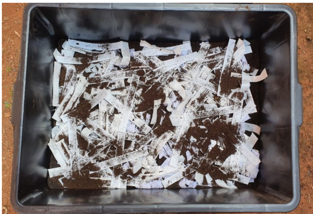
Figura 2. Montagem finalizada do mesocosmo de solo com exposição. Fotografia tirada em outubro de 2021
