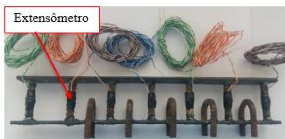
**Figura 3. 38 Extensômetros nas armaduras de cisalhamento.**
