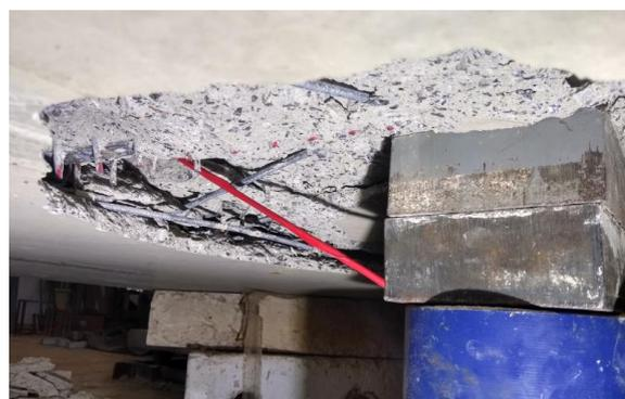
Verificação da superfície de ruptura.
