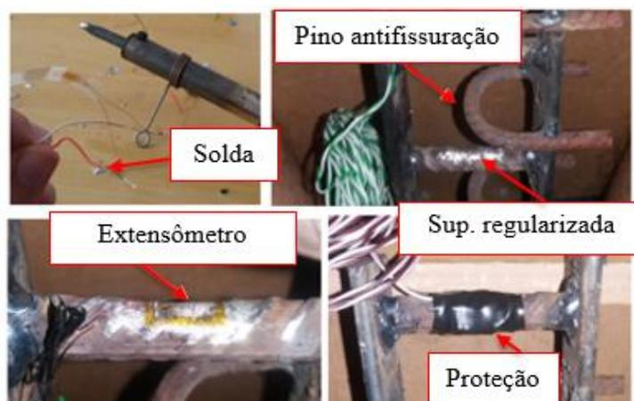
**Figura 3. 34 Etapas para instalação dos extensômetros.**
