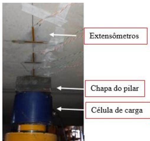
**Figura 3.42** Fotografia dos extensômetros de concreto na laje.
