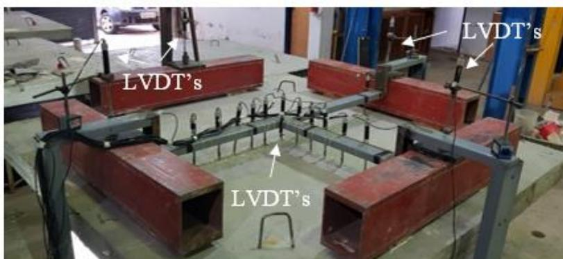
**Figura 3.32 Fotografia do posicionamento dos LVDT's.**
