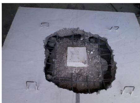
**Figura 2. 21 Ruptura típica de punção.**
