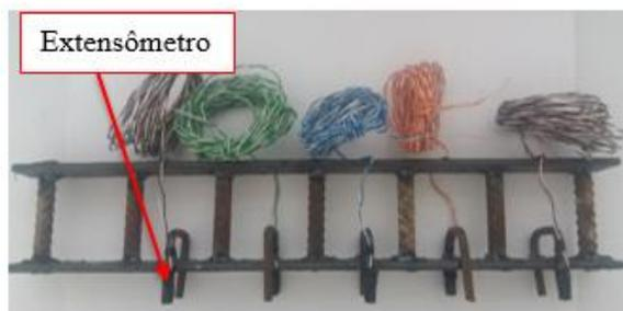
**Figura 3. 37 Extensômetros nos pinos antifissuração.**
