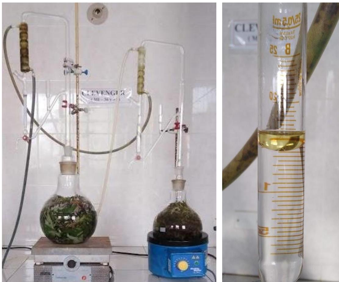
**Figura 5.** Extração do óleo essencial mediante hidrodestilação
