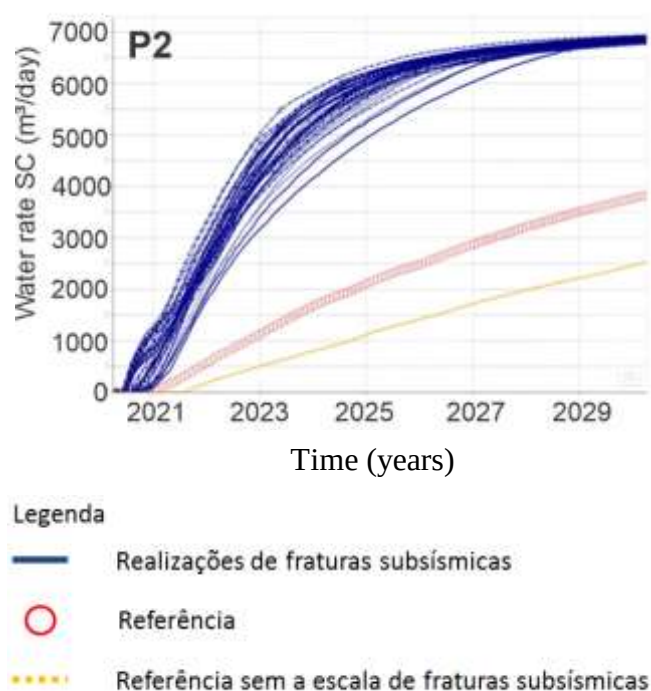
Figura 5.2. Gráfico de produção de água (m³/dia) versus tempo (anos) para o poço produtor P2. Resultados de simulação mostrando o impacto da dimensão fractal na produção de água no poço produtor P2. (Lima et al., 2023)
